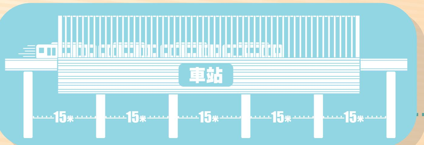
為達致節能環保的目的，澳門輕軌的高架車站均採用開揚及開放式的设计，營造自然採光及自然通風的效果，從而減少能源消耗。
