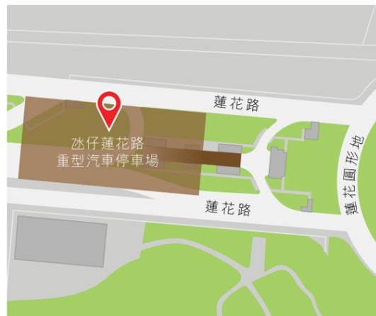
氹仔蓮花路重型汽車停車場共有兩層地下結構，而輕軌氹仔線的高架橋將設於停車場上方，因此，需要在停車場的範圍內建造24支樁柱及8支橋墩，以支撐上部的高架橋面。根據前期鑽探所得的資料，停車場位於新填海區，地下水位較高，因此必須要克服地下湧水的挑戰，以防止水土流失、路面下陷等情況發生。
