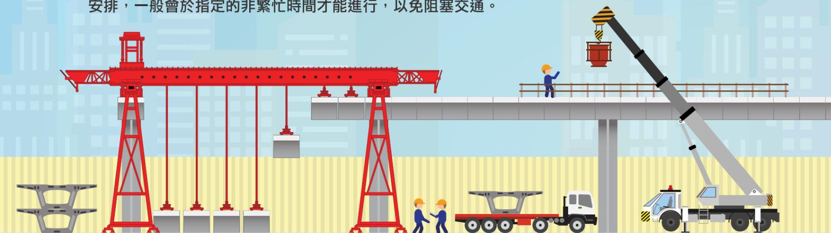
輕軌高架橋主要採用預製件吊裝方式建造，這種工法無疑令工地現場澆注混凝土的工序大幅減少，並能縮減在路面施工的範圍與時間。但是受地理條件的限制，高架橋也有一些部分是需要使用到現場澆注的方式建造，當中包括豎立於氹仔線的橋墩。這種現場澆注混凝土的施工方式，對於工程技術和天氣狀況都有很高的要求，建設團隊需要在現場施工前做好準備工作，並與各相關部門多方面協調溝通，方可順利開展。
