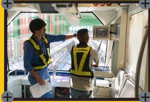
工程人員正於軌道上進行列車動態測試
