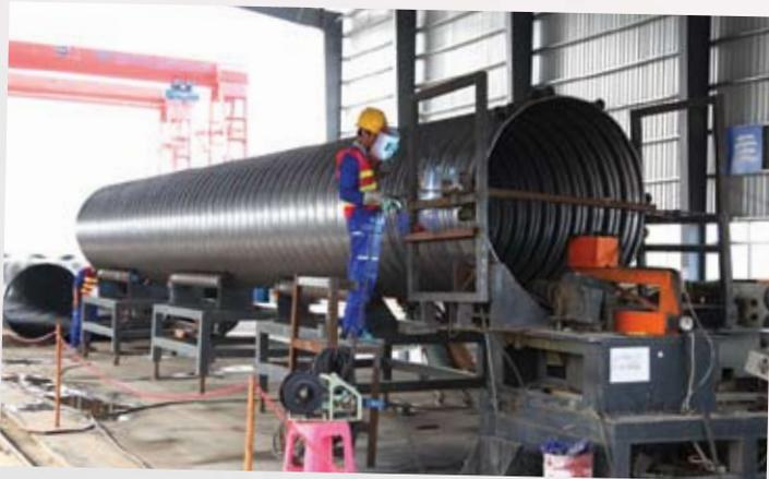
▲ 管套在臨時廠房內以鋼片壓製及焊接而成。
