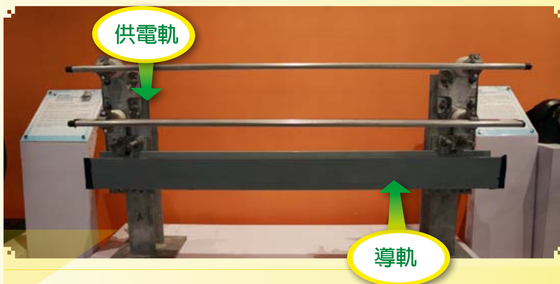
輕軌列車的導軌及供電軌
